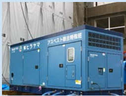
超高压水発生機
