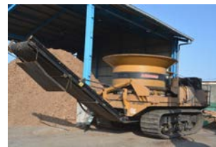
移動式木くず破碎機 (HC2410) 処理能力 377 t / 日
