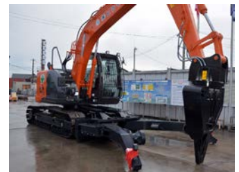
HITACHI ZAXIS135USMH(0.45m) セパレートアーム仕様
