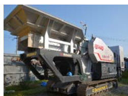
移動式コンから破碎機 (NJ250J) 処理能力 560 t / 日
