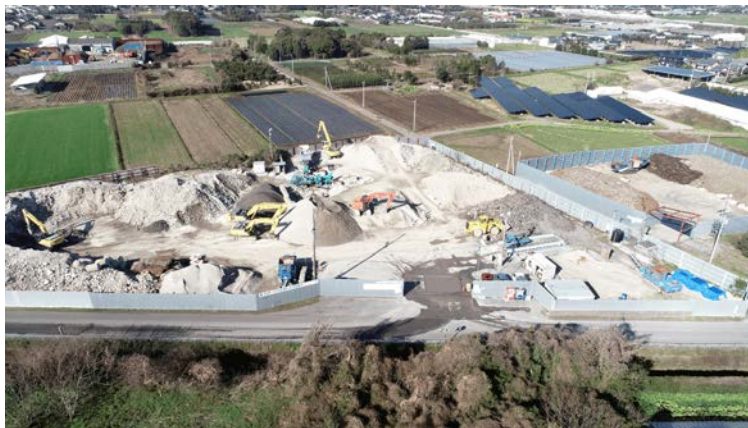
移動式コンから破碎機 (NJ250J) 処理能力 560 t / 日
