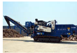
移動式木くず破碎機 (MC6000) 処理能力 75.68 t / 日
