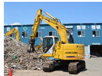
SUMITOMO SH225X(0.7m) エレベーターキャブ仕様 小旋回型
