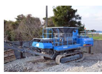
SUMITOMO ガラクシーSS180R 自走式コンクリートから破砕機
