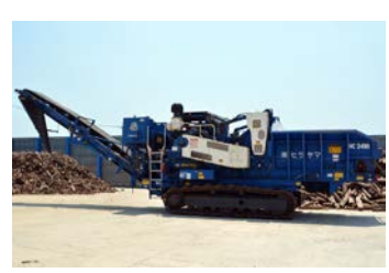
HITACHI HC-2410 自走式木材破砕機
