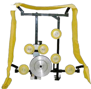
油圧式ワイヤーソー (W) 1.7m (L) 0.7m (H) 1.7m
