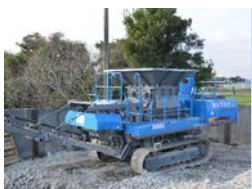
移動式コンから破碎機 (SS180RC) 処理能力 560 t / 日
