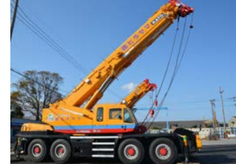
KATO SL-800Ri 75t ラフテレーンクレーン
