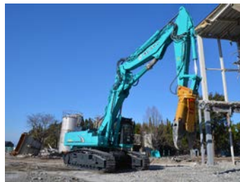
KOBELCO SK500LC(1.4m) セパレートアーム 解体仕様
