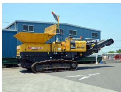
移動式万能破碎機 ガラパゴス (BR-300S) 処理能力 130 t / 日
