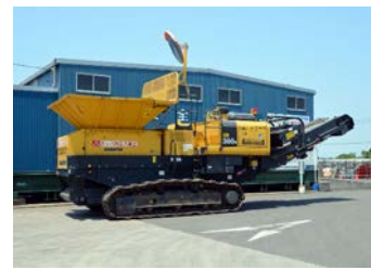
KOMATSU ガラパゴスBR300S-2 自走式ゴムくず / 金属くず / 繊維くず 破砕機
