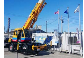
KATO MR-130Rf 13t ラフテレーンクレーン
